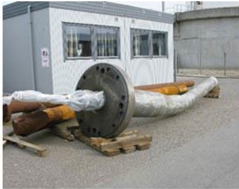
軸から1メートルずれるほど大きく曲がったプロペラシャフトと、その修理後の写真
