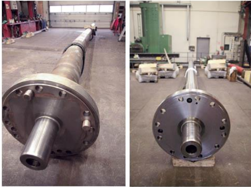
曲がったプロペラシャフトの冷間矯正の前・後の写真
