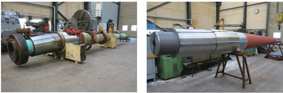
曲がったラダーストックの冷間矯正の前・後の写真
