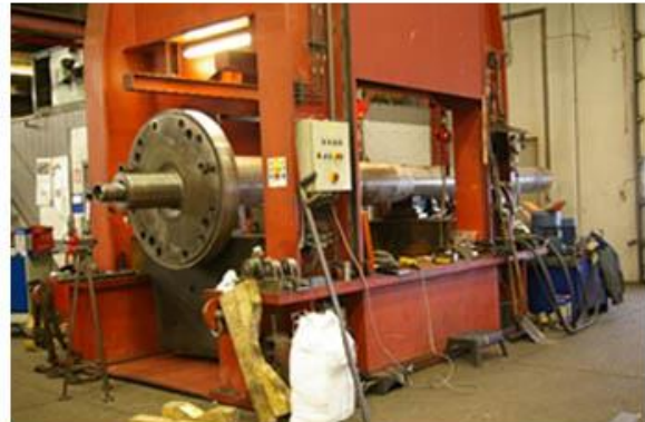
軸から1メートルずれるほど大きく曲がったプロペラシャフトと、その修理後の写真
