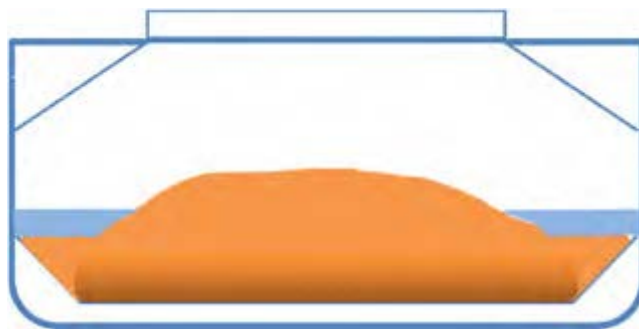
図 3. 水分が上方・外側に移動していくと、貨物の上方部分が沈み込んで平坦化していきます。貨物の隅には、より深く滞留する水の層が形成されます。船舶の揺れによって、この自由水面が跳ねるような動きをすることで、貨物の端が浸食されていきます。貨物の微粒子が水の中に閉じ込められ、スラリーが形成されます。
