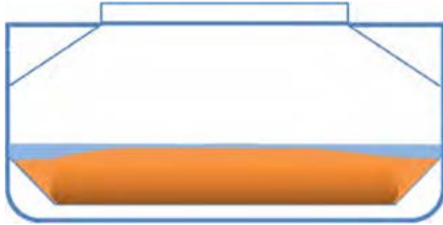
図 4. 水分の分離、貨物の沈み込み、貨物の端の浸食が進行すると、固形の貨物の上に滞留する自由スラリー表面が、カーゴホールドの全幅を覆うほどに広がっていきます。水分が上方に移動すると、超微細な微粒子もそれに伴って表面に留まるため、水分が貨物に戻って吸着されることもなくなります。
