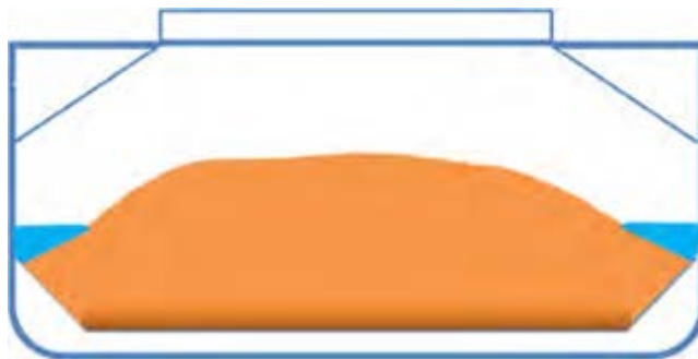
図 2. 船舶の揺れによって貨物が圧縮されていくと、貨物の下方に水分が移動します。貨物のどこかで水分含有量が限界レベルに達すると、貨物にかかる動的な力によって、隅・隔壁・壁境界の最も低圧な貨物の表面に水分が流れていきます。こうした水分の流れが続くと、貨物の水分が固形の貨物から分離し、カーゴホールドの隅に自由表面プールが形成されます。貨物の山の底辺にある固形の貨物と、カーゴホールドの中心にある貨物は、図 1 で示した船積み直後と比べて乾燥しています。貨物の表面にひびが入り始めているのが目視で確認できる場合があります。
