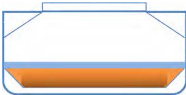
図 5. 動的分離が完了した後の、最終的な貨物の状態です。貨物は完全に平坦化し、自由表面スラリーの層がカーゴホールドの全幅を覆い、固形の貨物の上に滞留しています。点検を行わずにこうした状況を放置しておくと、この貨物の上に広がった自由表面スラリーの動きによって、船舶の復原性が低下し、転覆のリスクが高まるおそれがあります。
