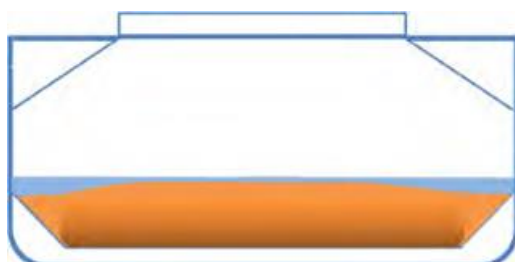
图 3. 水分向上方及外侧的运动，导致货物上部坍塌/变平。货堆角落处形成了更深的滞水层。船体运动时，这些晃动的自由液面冲蚀着货堆边缘。货物颗粒陷入水中，形成浆体。
