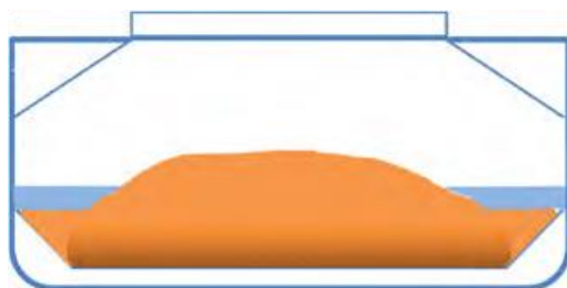
图 3. 水分向上方及外侧的运动，导致货物上部坍塌/变平。货堆角落处形成了更深的滞水层。船体运动时，这些晃动的自由液面冲蚀着货堆边缘。货物颗粒陷入水中，形成浆体。
