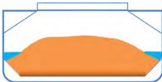
图 2. 由于船体运动，货物压实，造成水分向货堆底部移动。一旦货堆内部任何部位的水分含量达到了临界值，作用在货物上的动态力会导致水分流向最近的角落/舱壁/墙边界处压力较小的货堆表面。随着水继续流动，货物中的水分与固体货物分离，在货舱角落处形成几滩自由液面水。与图 1 中刚装上船时的货物相比，此时货堆底部的固体货物和货舱中央的货堆变得较为干燥。可以看到，货堆表面形成的裂缝。
